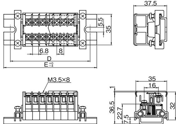
・レール組立完成品のレールは、AR-LH形を標準とし、外形図の様にUカットしたレールを使用しています。15mmピッチの穴あきレールではありません。また、他のレールにて組立完成品をご希望の場合、別途レール形式をご指示願います。
