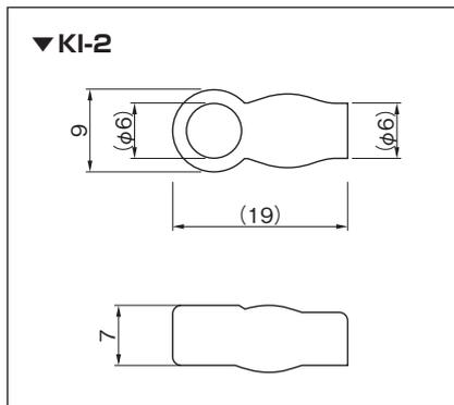
電球交換時の感電防止および導電部の絶縁に最適です。
